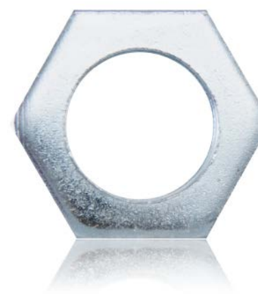
Tuerca de hierro hexagonal Cincado Azul Rosca: BSB 1/2"-26h Dim: 18,9 x3,00mm
