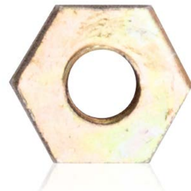
Tuerca De Hierro Exagonal Cincado Amarillo Rosca: W5/32" / W3/16" Dim: 7,80x2,20mm
