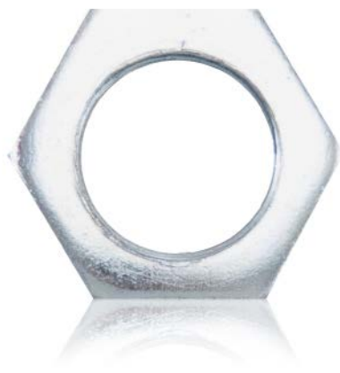
Tuerca De Hierro Hexagonal Azul Rosca: M 10x1mm Dim: 14 X 3,00mm
